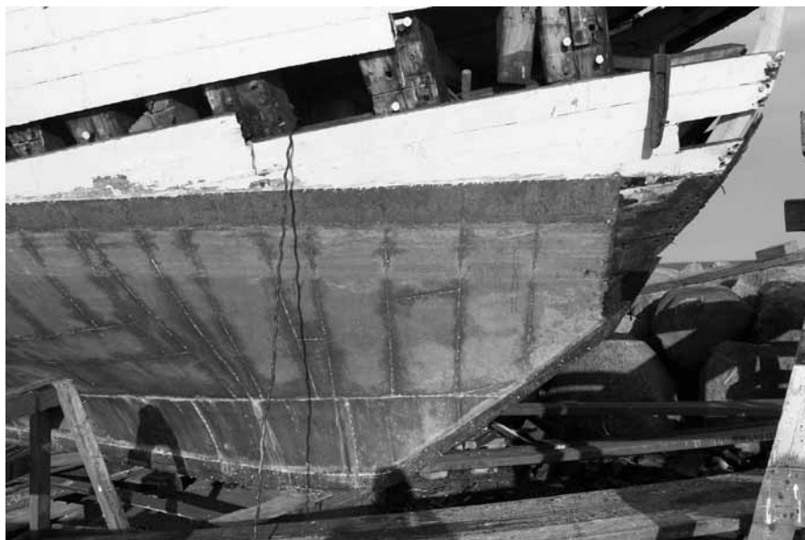
Lite kvar av vårjobbet. Kopparfärg är tveksam men kopparplåt är godkänt! Foto Bengt Nordé
